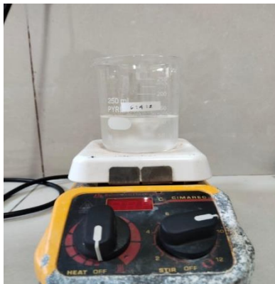
Gambar. 8 Pembuatan larutan scaffold
