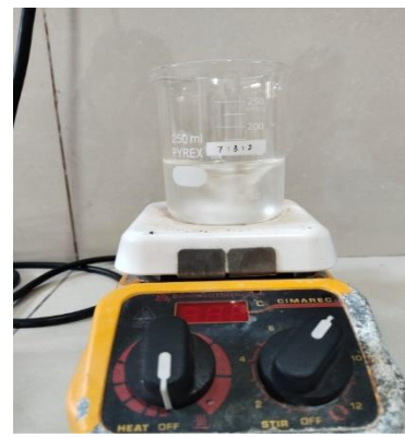
Gambar. 9 Pembuatan larutan scaffold
