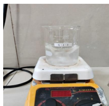
Gambar. 10 Pembuatan larutan scaffold 80:20:20
